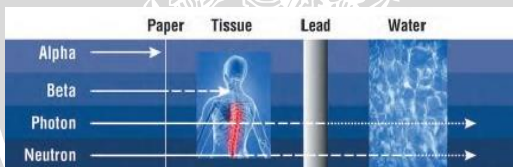
Gambar 2.5 Perbedaan Daya Tembus Radiasi Pengion (PWGSC, 2012)
