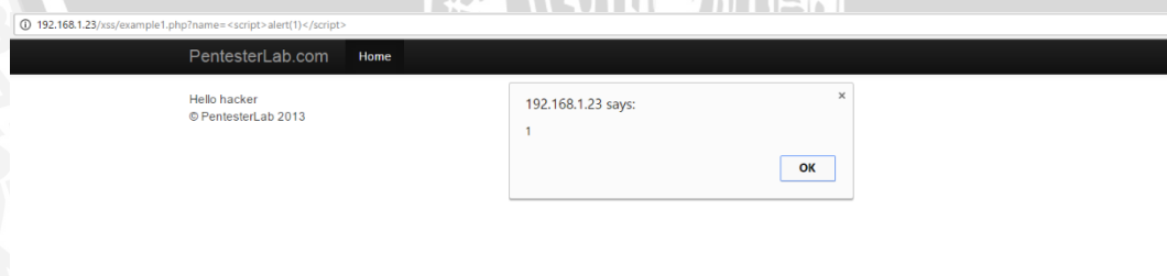
Gambar 5.1 Hasil Pengujian Manual XSS
