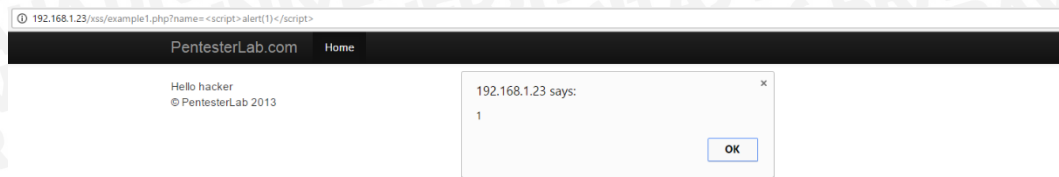
Gambar 4.3 Hasil Pengujian Manual XSS
