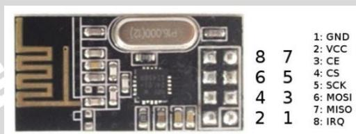
**Gambar 2.11 Pin Pada Modul nRF24L01**
