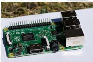
Gambar 2.1 Bentuk mini komputer Raspberry Pi 2
