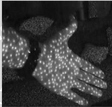
Gambar 2.3 Proyeksi dari infrared laser projector
