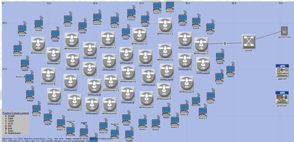
Gambar 4. 41 Bentuk topologi dari Wireless Mesh Network yang memiliki 32 router dan 40 client / host yang saling terhubung, switch, dan server dari voice. Topologi tersebut sudah disiapkan untuk skenario voice low load (PCM quality)
