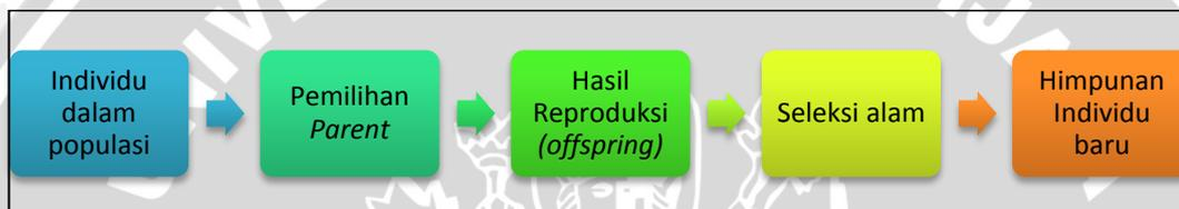
**Gambar 2.1 Proses-proses dalam Algoritma Evolusi**
