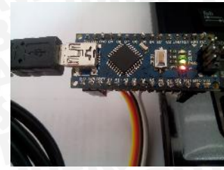
Gambar 8 Dua Indikator yang menyatakan Node Sensor tidak bermasalah
