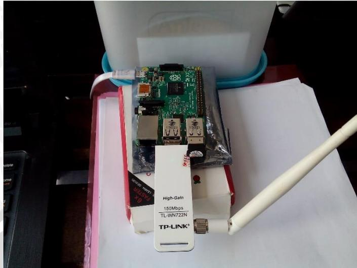
**Gambar 5. 22 Implementasi Perangkat Keras *Network bridge system***
