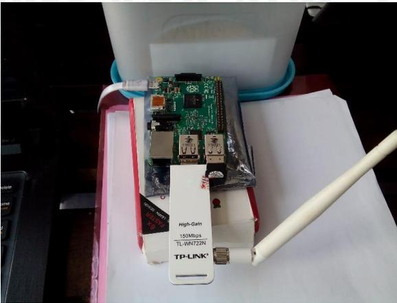
**Gambar 5. Implementasi Perangkat Keras Network Bridge System**
