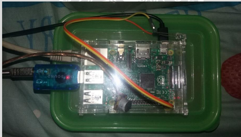
Gambar 5. 2 alat pendeteksi sirene ambulans
