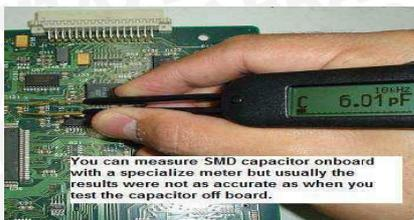
**Gambar 2.19** menguji SMD Kapasitor
