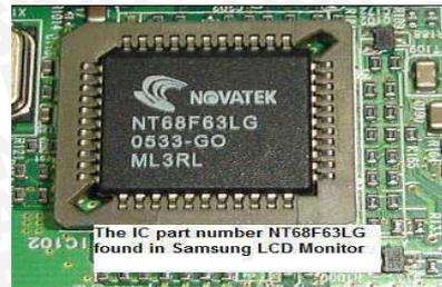
**Gambar 2.21 IC pada Samsung**
