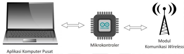
Gambar 5.2 Diagram Blok Perancangan Node Komputer Pusat
