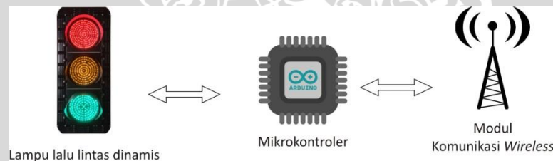
Gambar 5.12 Diagram Blok Perancangan Node Lampu Lalu Lintas
