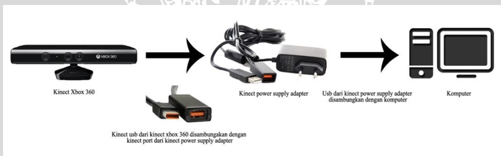
Gambar 3.4 Perancangan Sensor Kinect menuju komputer.
