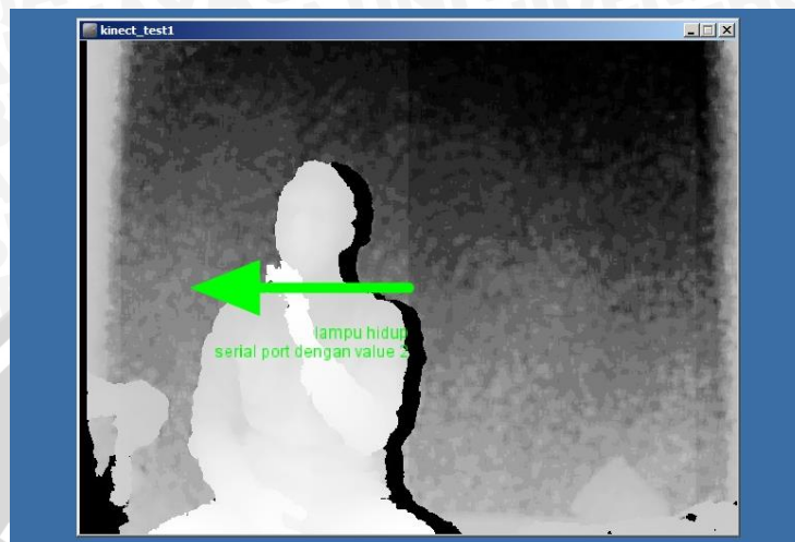
Gambar 5.3 Gerakan Geser Horizontal Ke Arah Kiri Terbaca Oleh Sensor Kinect.
