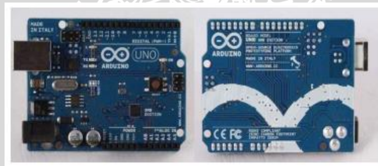
Gambar 2.7 Arduino Uno R3. Kiri: Sisi Depan; Kanan: Sisi Belakang (arduino, n.d.)
