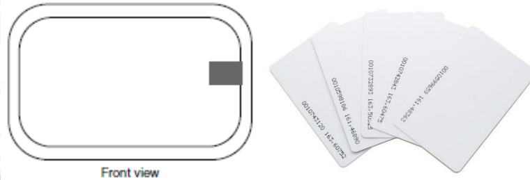
Gambar 2.4 Kiri : Layout RFID Card dengan Transponder Module dan Antenna (Finkenzeller, 2003) ; Kanan : RFID Card Transponder
