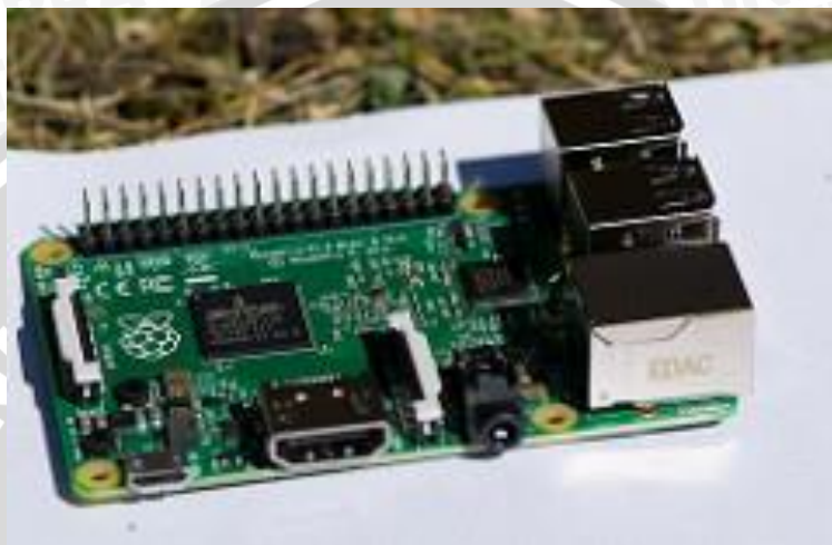
Gambar 2.10 Bentuk mini komputer Raspberry Pi 2
