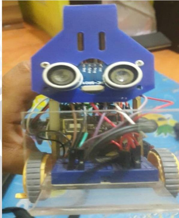
Gambar 4.15 Pemasangan sensor ultrasonik
