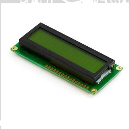
Gambar 2.9 LCD 16x2
