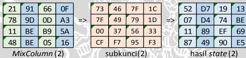
**Gambar 3.16** Hasil *state*(2) setelah dilakukan operasi *AddRoundKey*.
