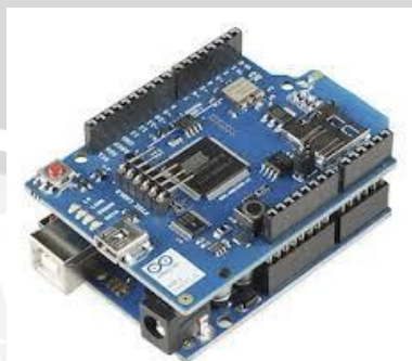
Gambar 4. 9 Pemasangan WiFi shield dengan arduino Sumber: [perancangan]
