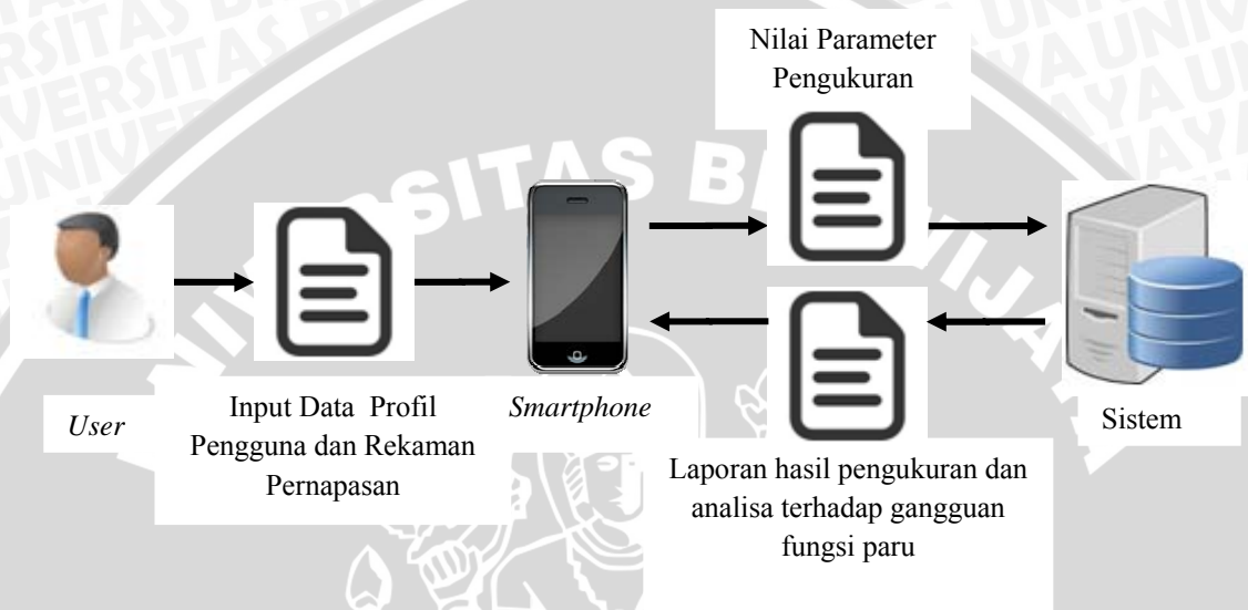
Gambar 4.2 Gambaran umum aplikasi pengukur kesehatan fungsi paru manusia memanfaatkan microphone pada smartphone
