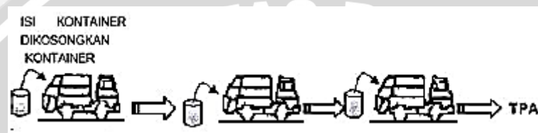
Gambar 2.8 Pola Pengangkutan Sampah dengan Sistem Kontainer Tetap
