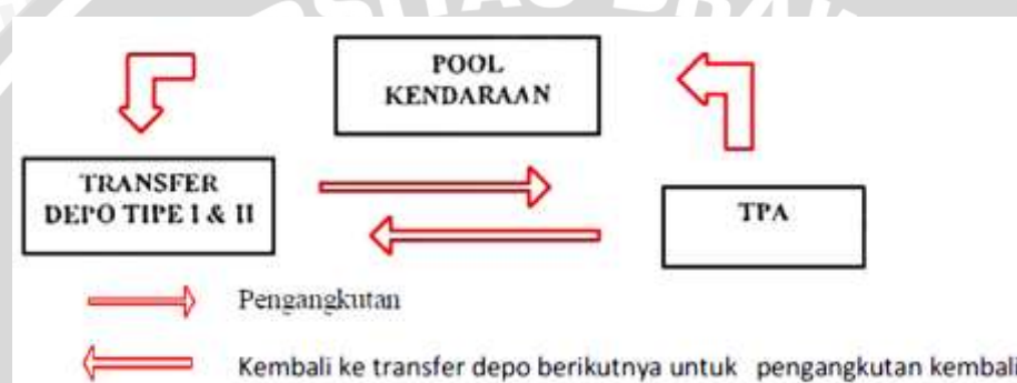
Gambar 2.4 Pola Pengangkutan Sistem Transfer Depo Tipe I dan II
