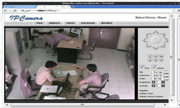
Gambar 6.3 Skenario Pengujian Konektivitas dan Monitoring Satu IP Camera dengan Raspberry Pi.
