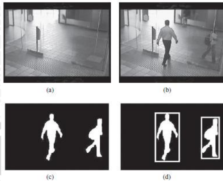
Gambar 2.6 a) Latar Gambar b) Latar Gambar dan Objek c) Hasil Background subtraction d) Objek yang terdeteksi.
