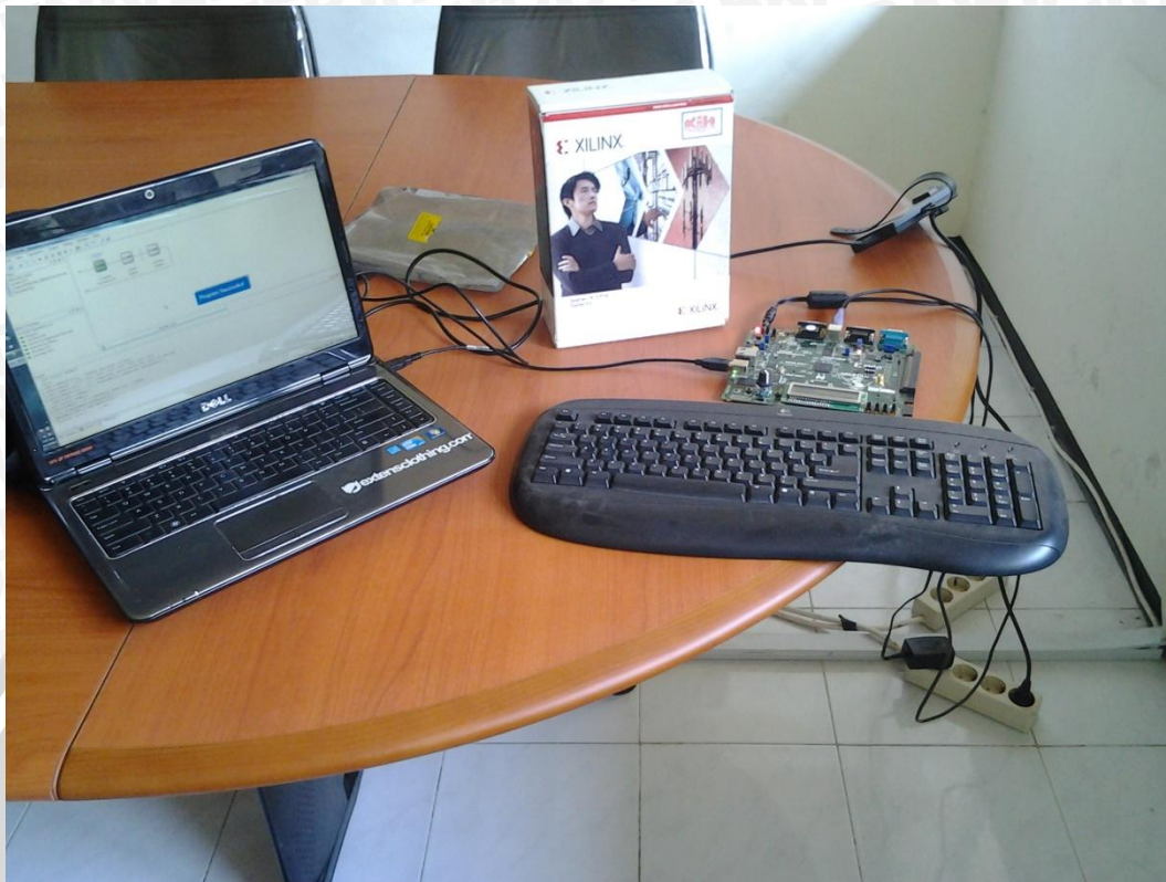
Gambar 4. 9 Menghubungkan Laptop FPGA dan Keyboard PS2
