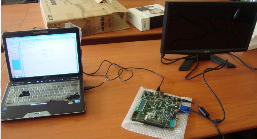
**Gambar4.10** Menghubungkan Laptop FPGA dan LCD Monitor
