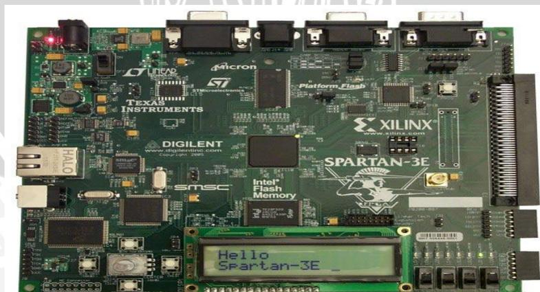
**Gambar 2.8** Fpga Spartan 3e
