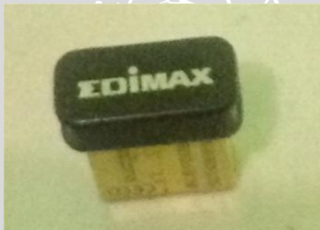
Gambar 4.2 Perangkat keras wifi adapter
