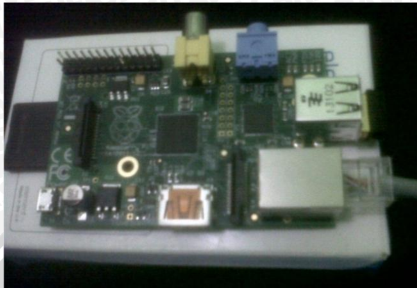
Gambar 4.1 Perangkat keras raspberry Pi model B
