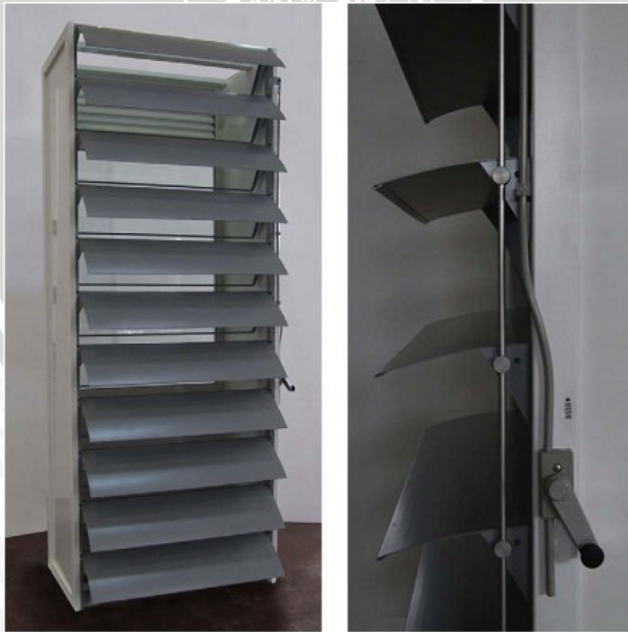
Gambar 2 Prototipe Model Desain Sistem Fasade Ganda Kombinasi Shading Mekanis ( Movable Shading ) dengan Konfigurasi Sistem Terbuka
