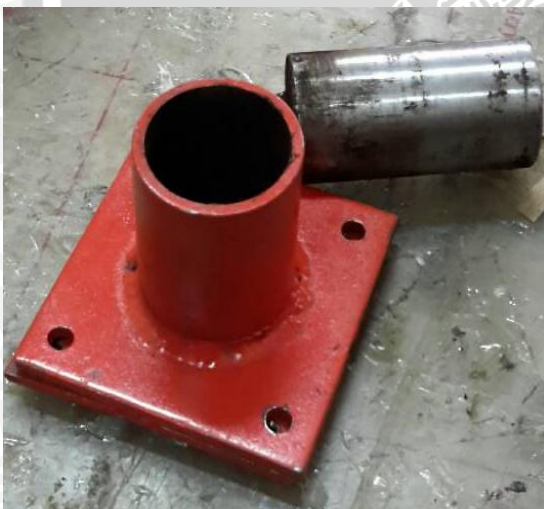
Gambar 3.9 (a) Cetakan Briket dan (b) Desain Cetakan Briket
