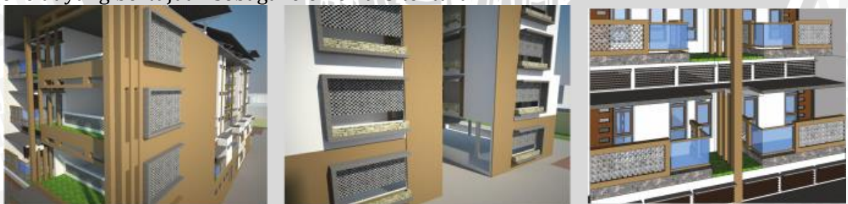
Material roster pada bukaan bangunan
