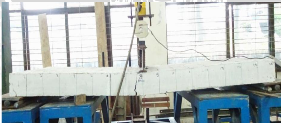
Hasil pengujian pelat tanpa styrofoam TS-2
