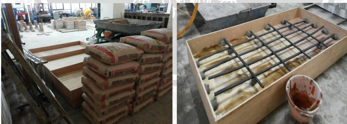
Persiapan dan material pembuatan benda uji
