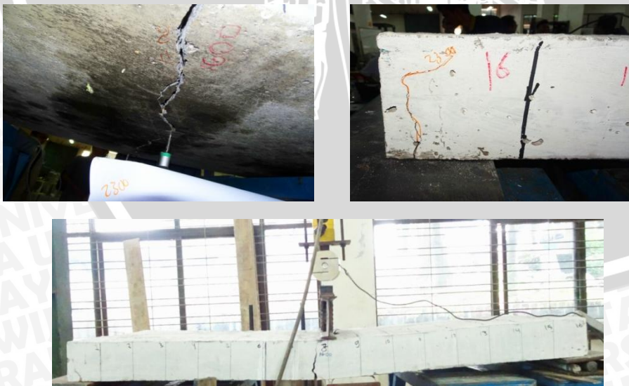
Gambar 4.13 Garis leleh pada pengujian lentur pelat TS-2 tanpa lapis styrofoam , satu arah
