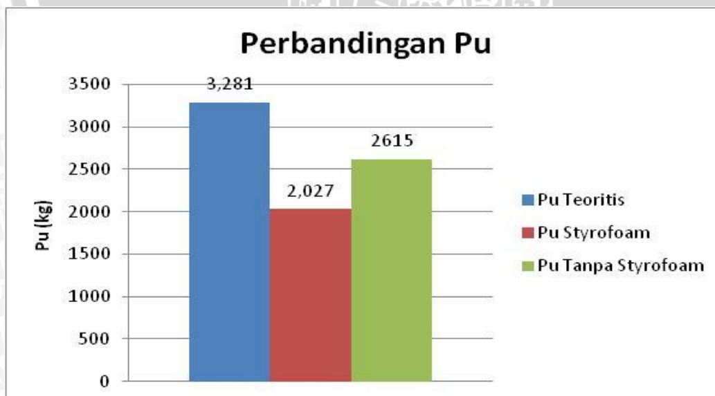
Gambar 4.12 Diagram beban maksimum rata-rata teoritis dan eksperimen pada pengujian lentur satu arah
