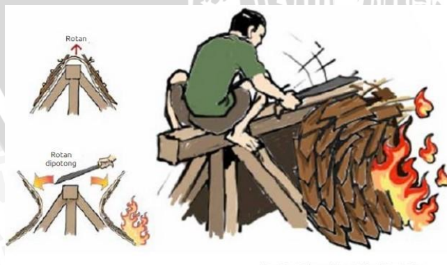
Gambar 4.223 Antisipasi Kebakaran pada Atap Sirap Sumber: Pasaribu, 2013
