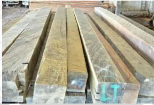
Gambar 4.9 Kayu Ulin sebagai Material Utama Rumah Lamin Adat Desa Pampang (sumber: www.multikayu.com .)
