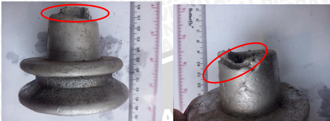
Gambar 4.3 : Porositas pada permukaan coran pulley allminium
