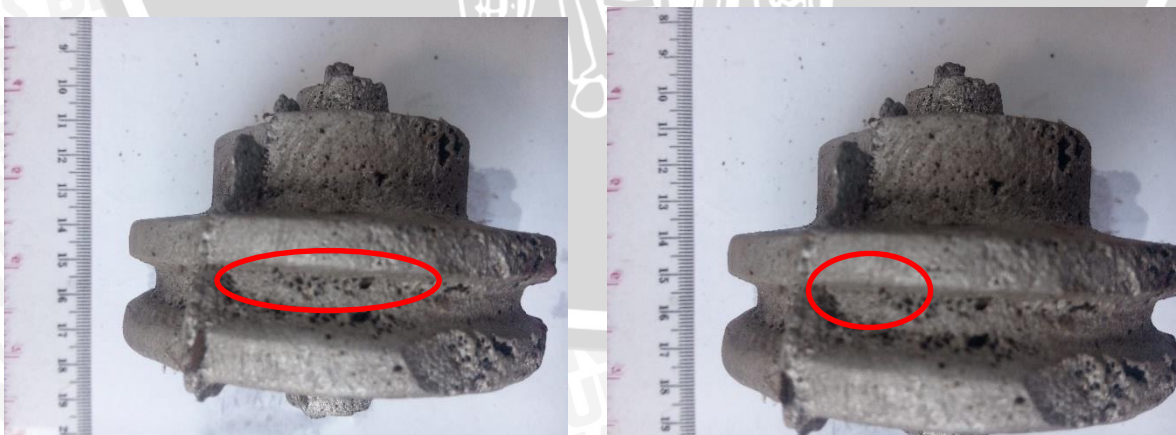
Gambar 4.5 : Porositas pada sisi permukaan coran pulley allminium
