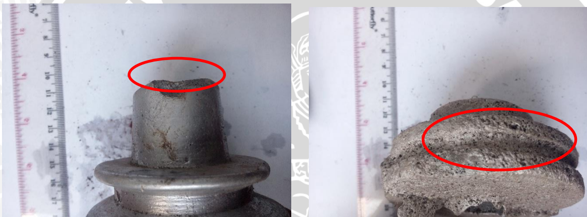
Gambar 4.4 : Porositas pada sisi permukaan coran pulley allminium
