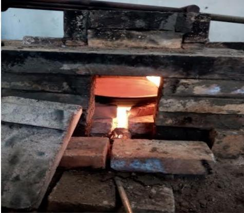
Gambar 3.1 Dapur Pengecoran
