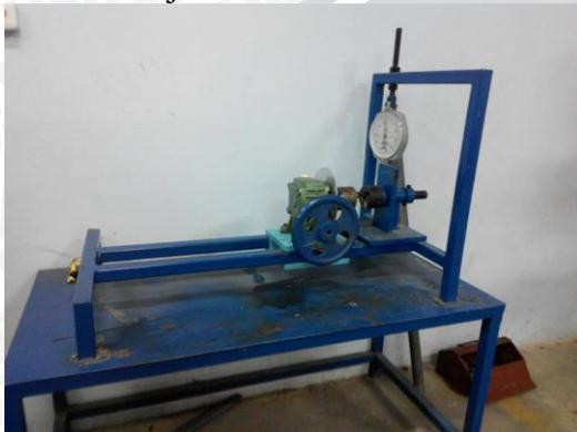
Gambar 3.7 Mesin Uji Puntir
