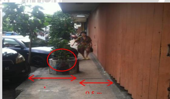
**Gambar 8.** Lebar Efektif dan Lebar Hambatan Segmen 2
