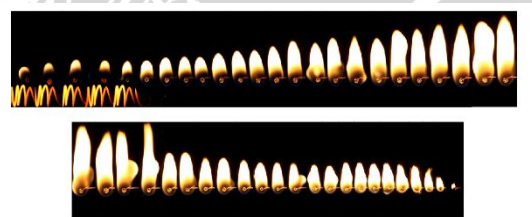
Gambar 6 Visualisasi pembakaran droplet biodiesel minyak jarak dengan campuran butanol
