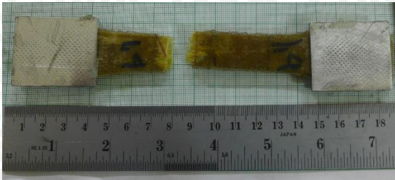
Gambar 8 Bentuk tampak atas patahan specimen Uji Tarik Orientasi (0°,90°)
