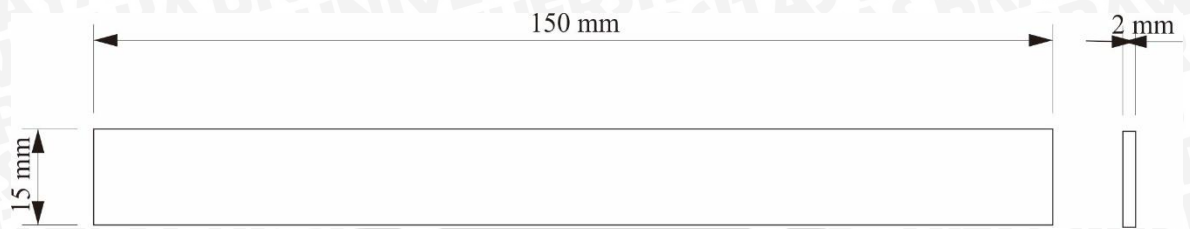
Gambar 3.1 Dimensi benda kerja dalam millimeter
