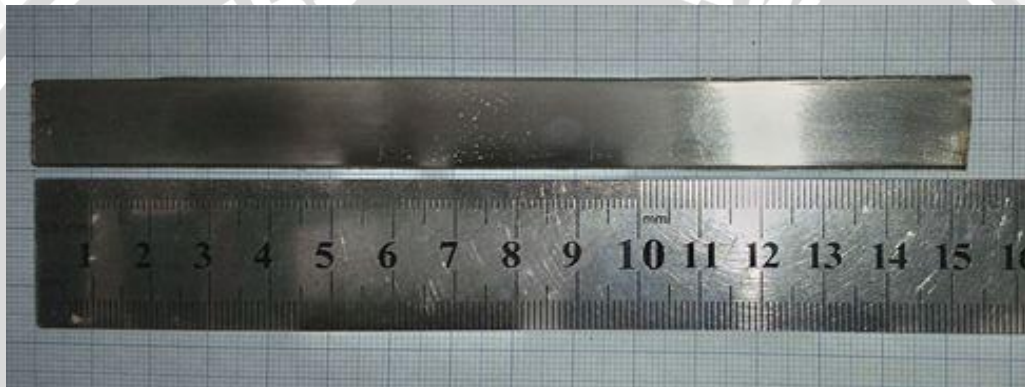
Gambar 3.2 Spesimen Shot peening
