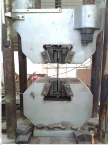
Gambar 4.3 Pengujian Tarik Tulangan Baja
