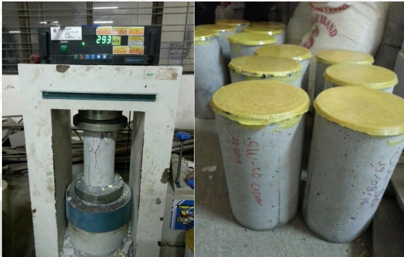
Gambar 4.1 Pengujian Kuat Tekan Beton
