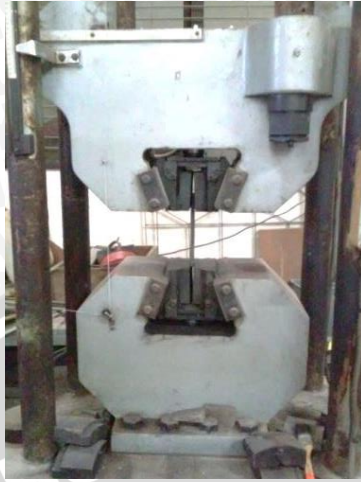
Gambar 4.3 Pengujian Tarik Tulangan Baja
