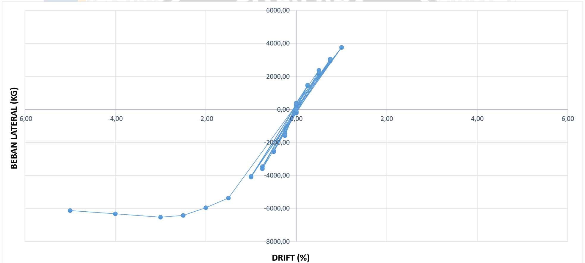
Grafik Histerisis Hubungan Beban dengan Drift Benda Uji DGK-75
