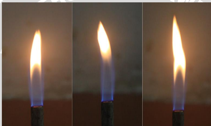
Gambar 4.8 Nyala Api minyak jarak mentah equivalence ratio 1,448
