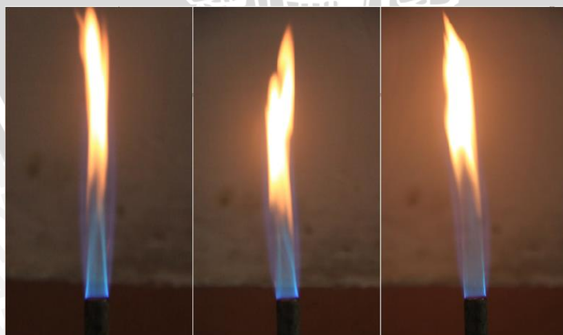
Gambar 4.9 Nyala Api minyak jarak mentah equivalence ratio 1,931
