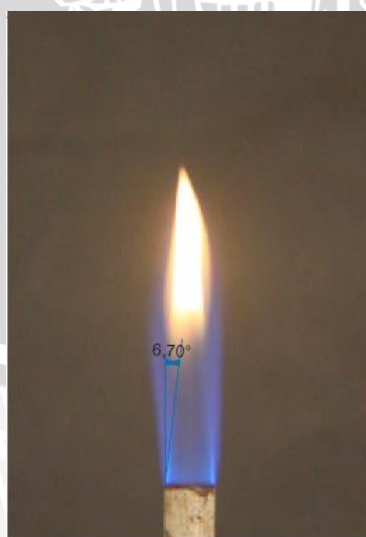
Gambar 4.2 Sudut api laminer minyak jarak non gliserol equivalence ratio 3,816
