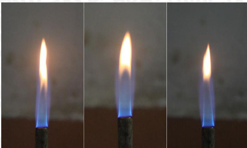
Gambar 4.7 Nyala Api minyak jarak mentah equivalence ratio 1,158
