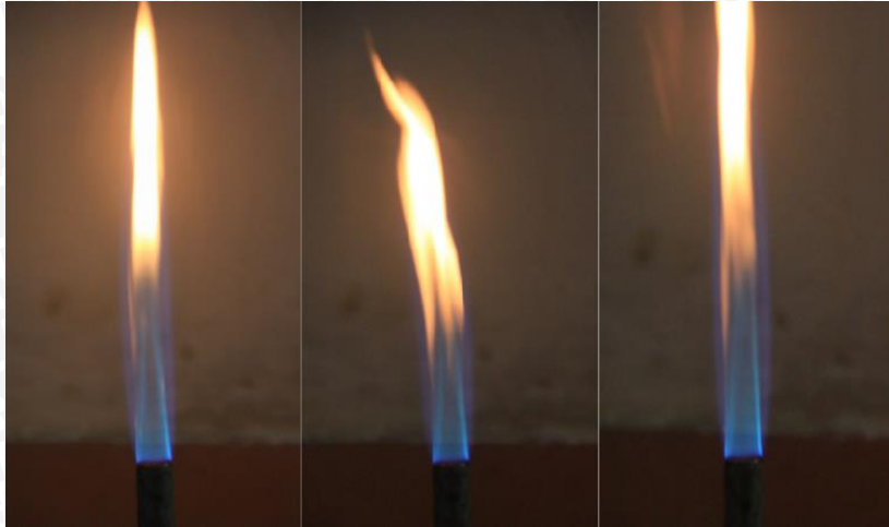
Gambar 4.10 Nyala Api minyak jarak mentah equivalence ratio 2,896
