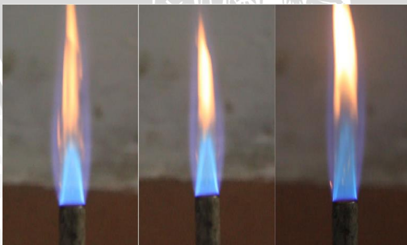
Gambar 4.6 Nyala Api minyak jarak mentah equivalence ratio 0,965
