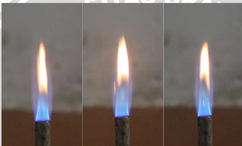
Gambar 4.5 Nyala Api minyak jarak mentah equivalence ratio 0,827
