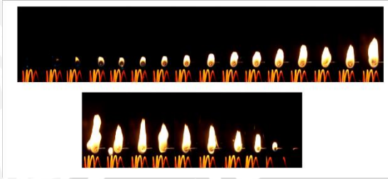
Gambar 6. Visualisasi pembakaran droplet minyak jarak dengan campuran butanol
