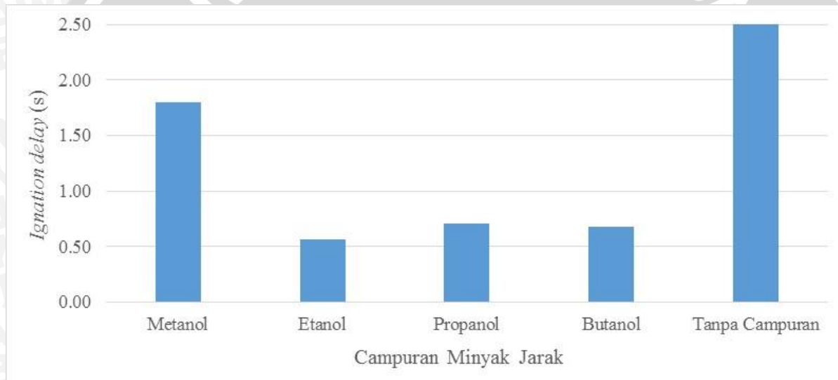
Gambar 4.2 Grafik pengaruh variasi campuran minyak jarak terhadap ignition delay time droplet minyak jarak
