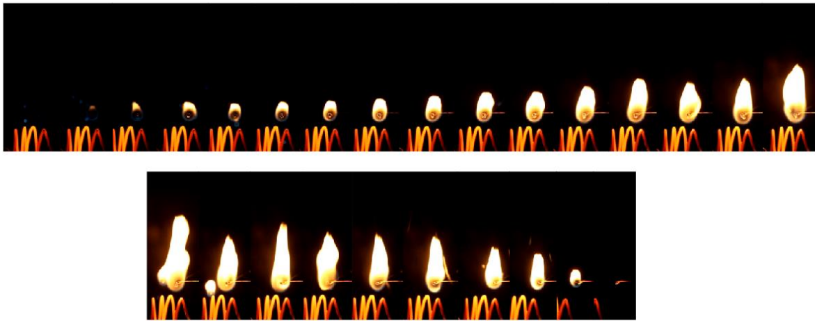
Gambar 4.6 Visualisasi pembakaran droplet minyak jarak dengan campuran butanol
