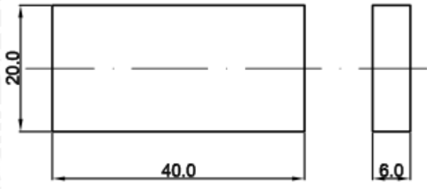
Gambar 3.7 Dimensi spesimen dengan luas selimut 2320 mm 2
