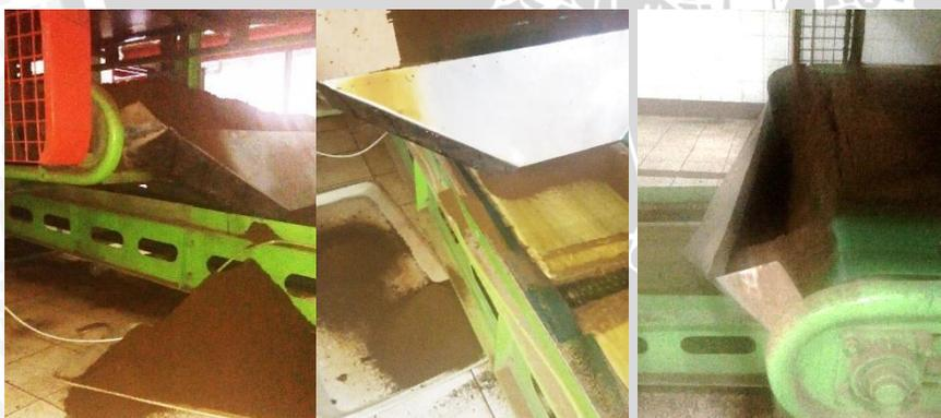
*Gambar 4.18* Bubuk Teh yang Tercecer pada *Fermenting Machine* dan Perbaikan yang Diterapkan Perusahaan
