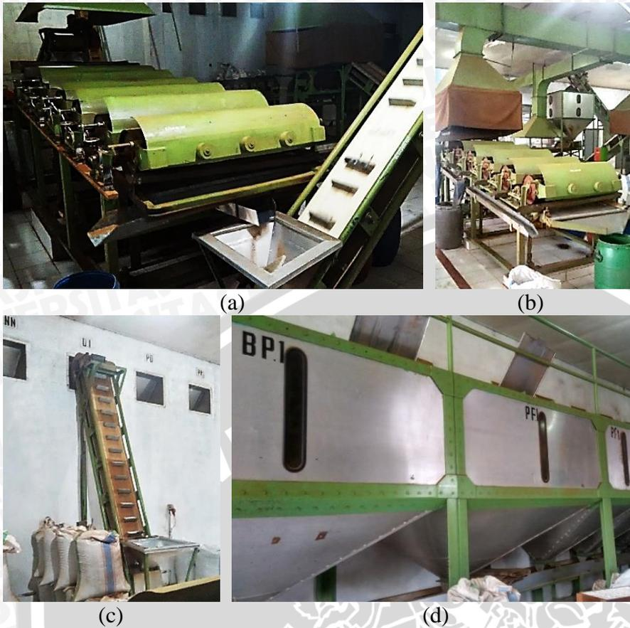
Gambar 4.8 Mesin Vibro Jumbo (a), Mesin Trinick (b), Konveyor (c), Tea Bin (d)
