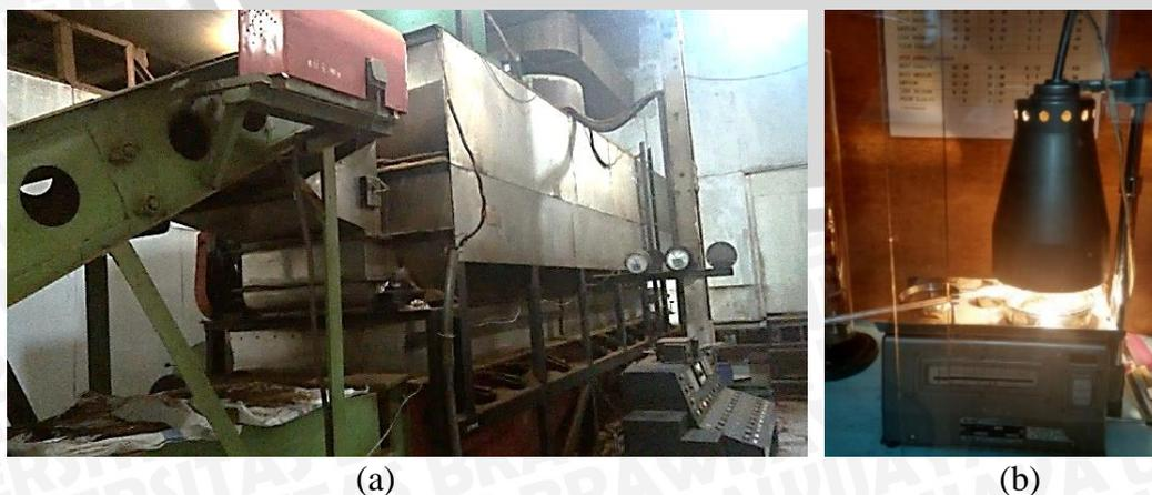
Gambar 4.7 Mesin VFBD (a), Pengukuran Kadar Air dengan *Kett Infrared* (b)
