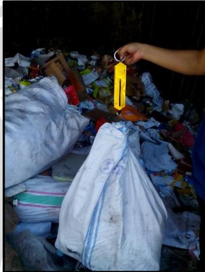
Gambar 3. 3 Pengukuran berat sampah yang tereduksi di TPS Bentoel
