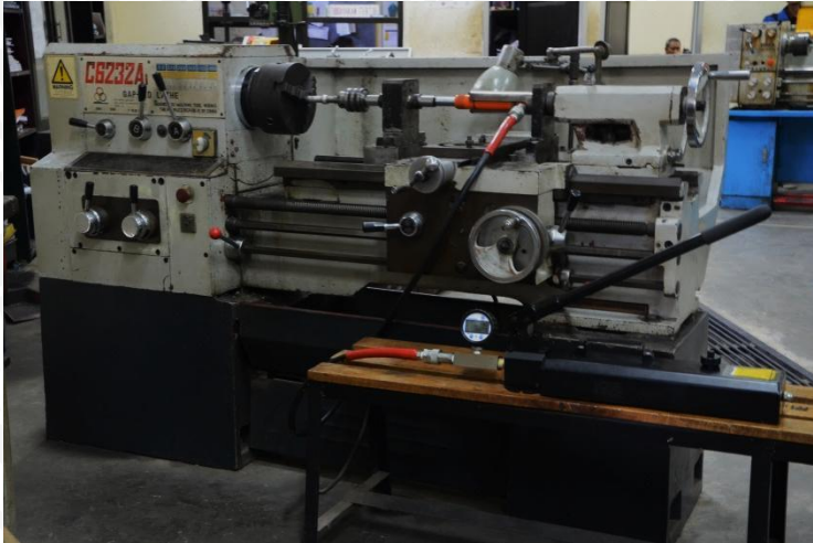
Gambar 3.2 Mesin Untuk Pengelasan Gesek Sumber: Laboratorium Proses Produksi I Teknik Mesin Fakultas Teknik Universitas Brawijaya
