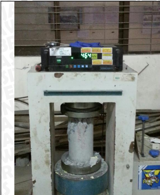
Uji Tekan Silinder Beton
